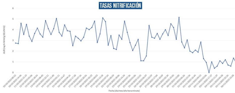
Figura 5. Tasa de nitrificación en mg N-NH 4 /(g SSLVM-h), noviembre de 2023. (Respirómetro SN8)
